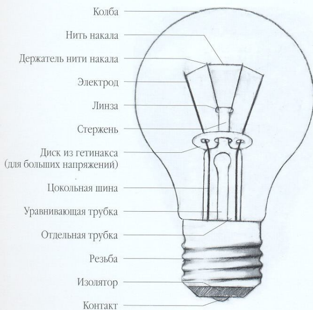
155. Устройство лампы накаливания.
