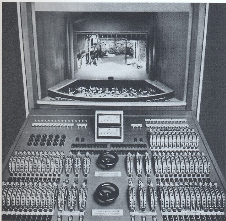
392. Устройство управления на тиратронах с пресетами и фейдерными колесами, 1955
