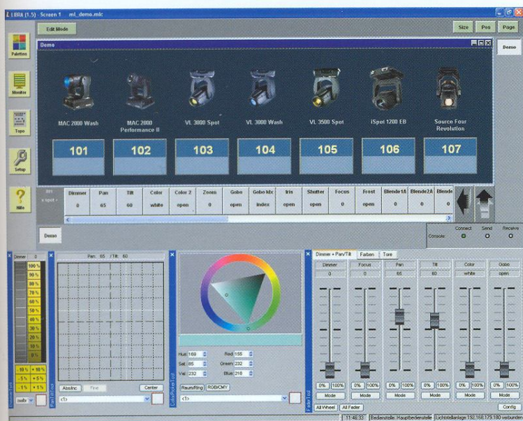
380. Страница пользовательского интерфейса сенсорной панели Libra. Панель полностью встроена в блок управления освещением Transtechnik NT (X). Свободно программируемый интерфейс обеспечивает простой выбор устройств и назначение параметров. На странице показаны опции выбора: в середине так называемый указатель цвета (colour picker), справа – фейдеры для задания дополнительных параметров
