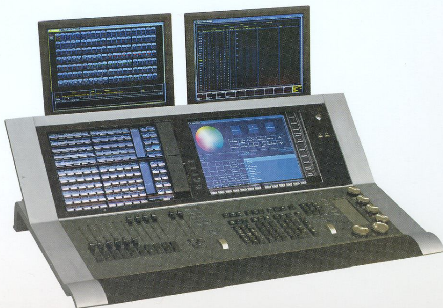
381. Гибридный пульт управления EOS от компании ETC. До 5000 устройств; отдельные фейдеры для функции "playback"; 10 моторизованных фейдеров с 30 страницами памяти; 2 жидкокристаллических сенсорных экрана 15"; ETCNet2, Net 3/ACN, RDM, MIDI, SMPTE
