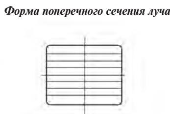
Параболоцилиндрический симметричный отражатель имеет определённую фактуру — рифление или матирование для лучшего рассеяния.
