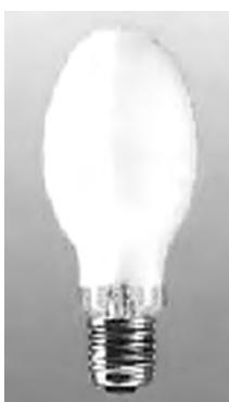
Лампы типа ДРЛ представляют собой ртутную горелку в виде трубы из прозрачного кварцевого стекла, вмонтированную в колбу из тугоплавкого стекла. Внутренняя поверхность внешней колбы покрыта тонким слоем порошкообразного люминофора. Колба снабжена резьбовым цоколем.
